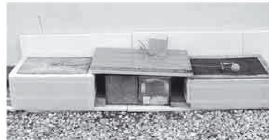
Obrázek 4: Zkušební tělesa pro měření chování při oteplování na střeše budovy Výzkumného ústavu asociace rakouského cementového průmyslu (Foto VÖZFI)
