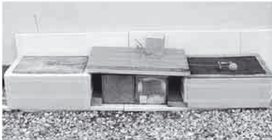
Abbildung 4: Versuchskörper zur Messung des Erwärmungsverhaltens am Dach des Institutsgebäudes der Vereinigung der österreichischen Zementindustrie [Foto VÖZFI]
